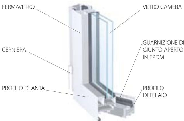
I sistemi non isolati sono adatti alla realizzazione di porte e finestre nelle più svariate tipologie, la gamma per finestre utilizza il concetto costruttivo del giunto aperto per garantire al manufatto un'elevata tenuta agli agenti atmosferici.
